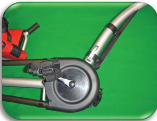
Označte si místo, kde máte uchycenou sedlovku v rámu kola. Vytáhněte sedlovku z rámu kola. Vyberte plastové pouzdro dle velikosti vaši sedlovky a nasuňte ho na ni přírubou dolů. Pouzdro na sedlovce by mělo pevně držet, ale zároveň umožňovat snadné otáčení duralového závěsu.
